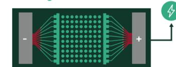
Durante le applicazioni più gravose, con le batterie con tecnologia tradizionale, l'energia passa in zone ristrette (stringhe, "tabs") con alta intensità. Questo provoca un surriscaldamento e l'interruzione del lavoro, lasciando una parte di energia inutilizzata.
