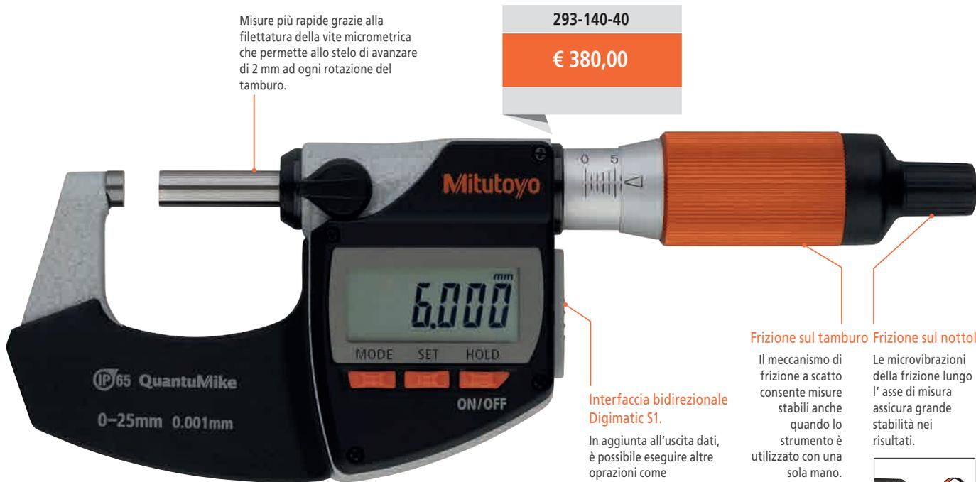
Misure più rapide grazie alla filettatura della vite micrometrica che permette allo stelo di avanzare di 2 mm ad ogni rotazione del tamburo.
